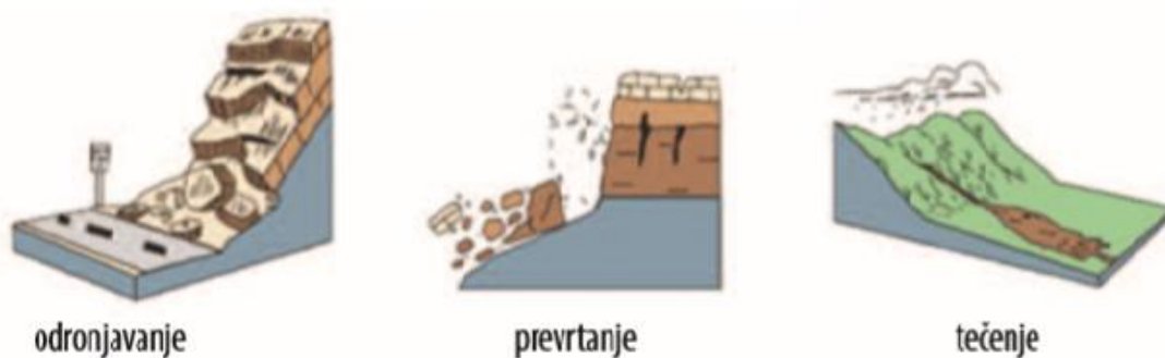
Slika 22: Prikaz osnovnih tipova klizanja prema mehanizmu kretanja
